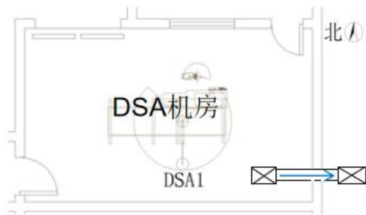
图10-4 DSA机房排风路线图
