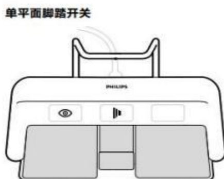
图10-6 DSA脚踏透视曝光开关示意图
